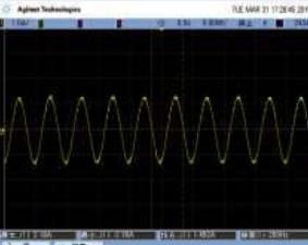
Форма тока при стабильной работе в режиме векторного управления на частоте 200Гц
