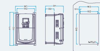
Фланцевый монтаж преобразователей 37 ~ 110кВт
