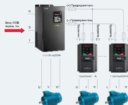
На схеме ниже показано подключение асинхронных двигателей. Подключение происходит за счет подачи управляемого сигнала с релейных выходов R01 и R02 на контакты KM0 и KM1 соответственно. Дополнительные двигатели подключаются к питанию сети если значение напряжения с ОС не совпадает со значением опорного давления. Преобразователь частоты автоматически поддерживает постоянное давление путем ПД/регулирования на основе обратной связи по давлению.
