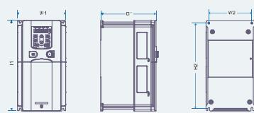
Схема установки для ПЧ 11—15кВт
