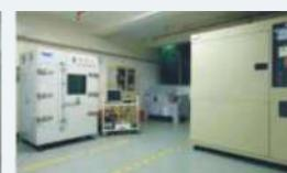
Камера испытаний на естественную конвекцию (слева)
