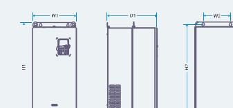
Фланцевый монтаж преобразователей 132 ~ 200кВт
