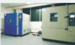
Камера испытаний на воздействие низкого давления (слева)
