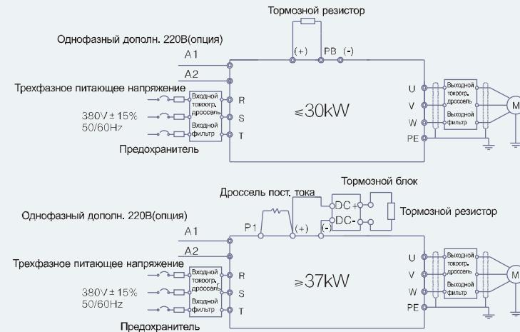
Схема подключения цепи управления
