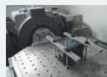
Система вибрационных испытаний с электромагнитным возбудителем
