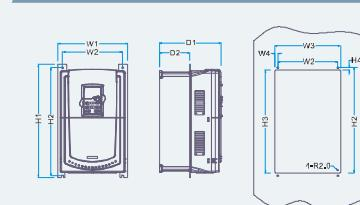
Фланцевый монтаж преобразователей 18 ~ 55кВт
